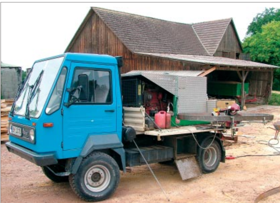
Abb. 3: Auf dem Multicar M 26 hat Haas ein Stromerzeuger und eine automatische Schärfenrichtung installiert.
