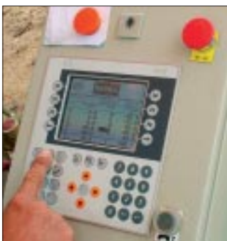
Abb. 2: Auch bei Sonnenschein ist das Display des neuen „Bordcomputers“ dank der möglichen Helligkeitsregulierung sehr gut abzulesen.
